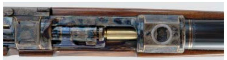
**Lauf.** In den Hülsenkopf ist ein 56 cm langer Lauf von Lothar Walther eingeschraubt. Er hat Matchqualität. Der Lauf verjüngt sich von 29 mm Durchmesser an der Wurzel auf 16,5 mm Mündungsdurchmesser. Die ersten 4 cm des Laufes verlaufen in klassischer „Mauser-Form“ zylindrisch. Die sechs breiten Kannelierungen tragen wesentlich zum attraktiven Erscheinungsbild der Büchse bei.
