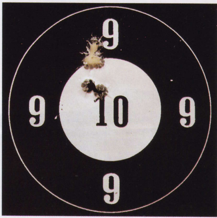
Handladung 5: Der ermittelte Streukreis-durchmesser beträgt 22 mm.
