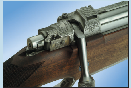
3. Stellung Transportsicherung – Hebel gesperrt –
