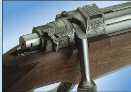
2. Stellung gesichert, Kammer zu öffnen – Pirschsicherung –
