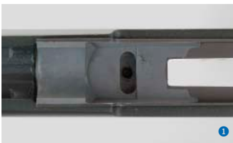
1 Blick in den Schaft. Das System liegt in einer Kunststoffbettung im Schaft. In der Mitte ist die Ausnehmung für den breiten Rückstoßstollen zu erkennen.
